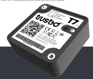
Das T7LTE basiert sich auf die Low-Power-Netzwerktechnologie LTE Cat-M1, bei einer Berichtsfunktion von 1 Position pro Tag unter normalen Umständen eine Batteriespanne von 5 Jahren vorweisen kann.
